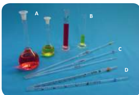
Figura 10 – Material de laboratório: balões volumétricos (A); provetas (B); pipetas, volumétricas e graduadas - (C e D).
